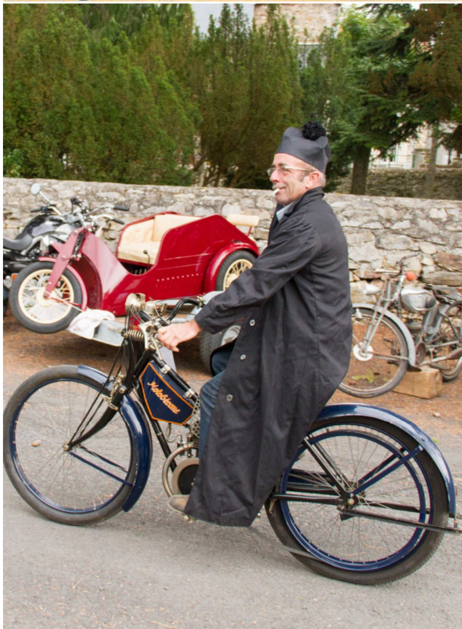
Motobécane, frame met lage instap, riemaandrijving, 98 cc BMA (Foto: Daan Withagen)
