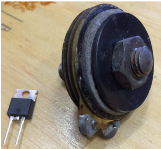
De oude condensator, in de Gnome & Rhône is vervangen door een modern exemplaar. Functie: vermijden van vonken aan de contactpunten.
