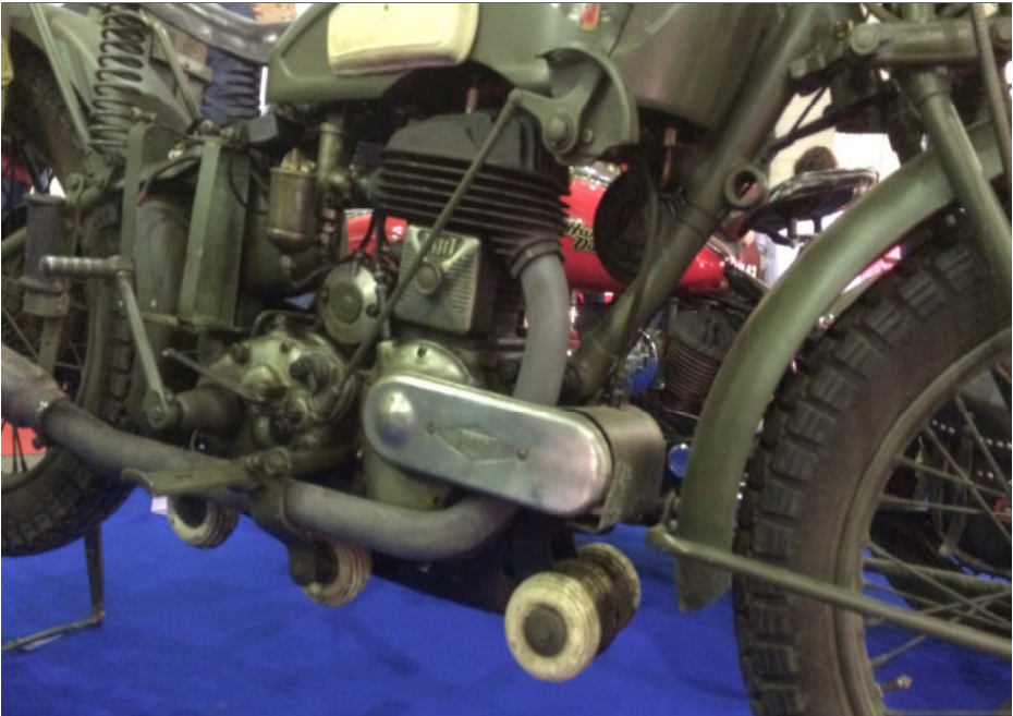
Terrot RATT (met drie rollen onder het motorblok). Een 500 cc zijklepper uit 1936 met een vermogen van 11,5 pk en een maximum snelheid van 90 km/h.
